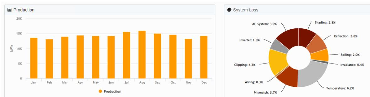
Figura 2. Relatório de geração e perdas do sistema. (HelioScope, 2024)
